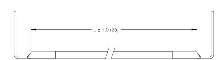
FACTORY CRIMPED #6 AWG FRONT TO BACK RAIL JUMPER GREEN/YELLOW INSULATION (QTY. 2)
